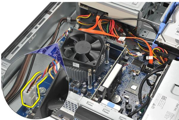
4. Dévissez les vis imperdables qui fixent le bloc dissipateur thermique/ventilateur à la carte système.
